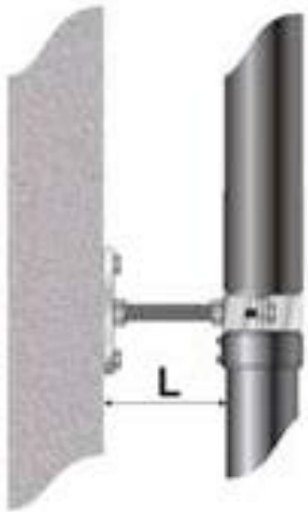
25. ábra: Ejtővezeték rögzítése merev szerkezethez
